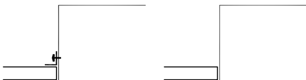
Montaż oprawy w suficie G/K Fixture mounting in plasterboard ceiling
