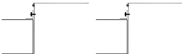
Montaż oprawy w suficie przystosowanym do chodzenia Fixture mounting in walkable ceiling
